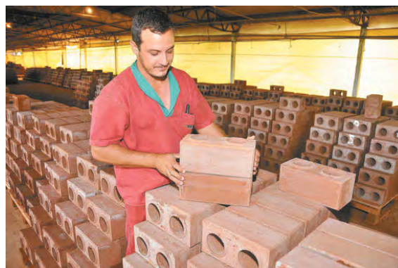
Figura 5: Exemplo de tijolo ecológico, feito de solo, cimento, bagaço de cana-de-açúcar e restos de obra. Fonte: EcoMáquinas. Disponível em < http://ecomaquinas.com.br/noticias/351 >, acessado dia 25/05/2013.
