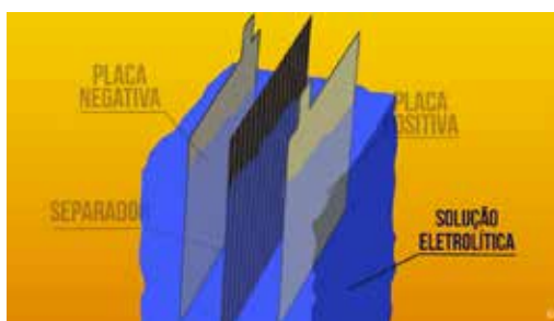
Figura 4 13 : Esquema da disposição das placas dentro dos compartimentos nos automóveis tradicionais, a placa negativa é esponjosa e a positiva composta por peróxido de chumbo. 2017
