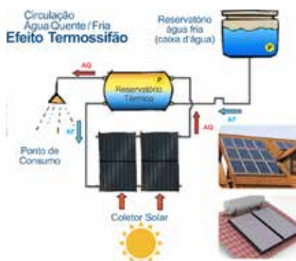
Figura 7. Esquema de funcionamento de um coletor solar 23 .
