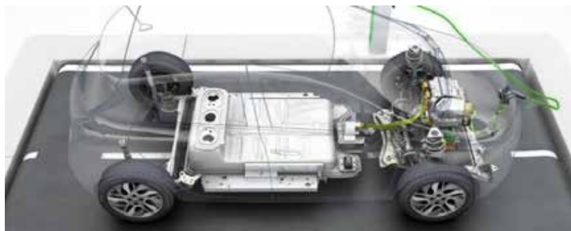
Figura 3 o : Representação do Renault Zoe, onde o local representado pela bateria, ocuparia o espaço do tanque de gasolina e do sistema de escapamento nos carros tradicionais, 2017
