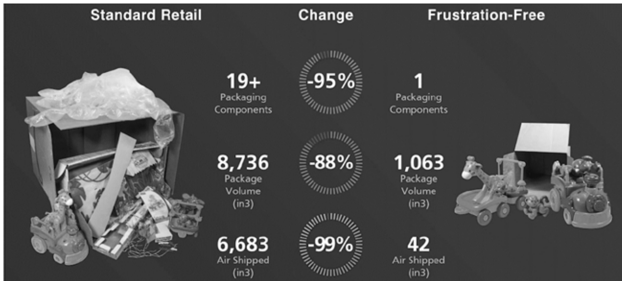
Imagem 12 – Comparação entre a embalagem original do produto (à esquerda) e a embalagem FFP (à direita). Entre as duas imagens, estão os números comparando as composições das caixas: na primeira linha, é comparado o número de componentes utilizados em cada caixa; na segunda, o volume de cada embalagem em polegadas cúbicas e na terceira, o volume de ar enviado, ou seja, o volume vazio da embalagem, em polegadas cúbicas.
